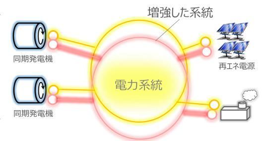
インバータ電源は同期 化力を持たないため 系統増強による同期化 力向上効果はない
