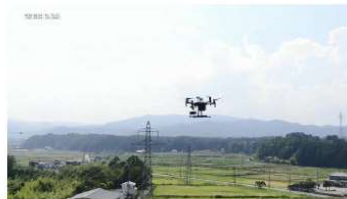
ドローンによる「送電線自動追尾点検」の実証実験の様子 (2019年7月～8月に、福島県内で実施)
