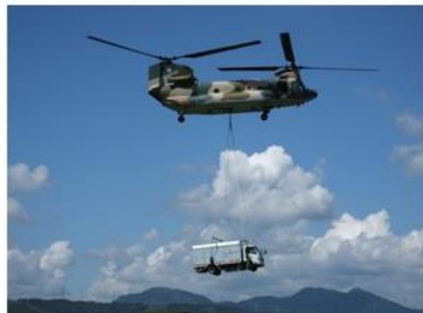
航空自衛隊の大型輸送ヘリコプターによる高圧発電機車の懸吊訓練
