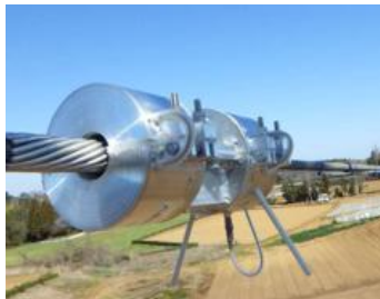
送電線取付センサー
