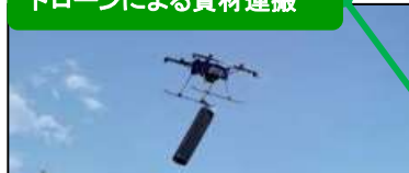
ドローンによる資材運搬
